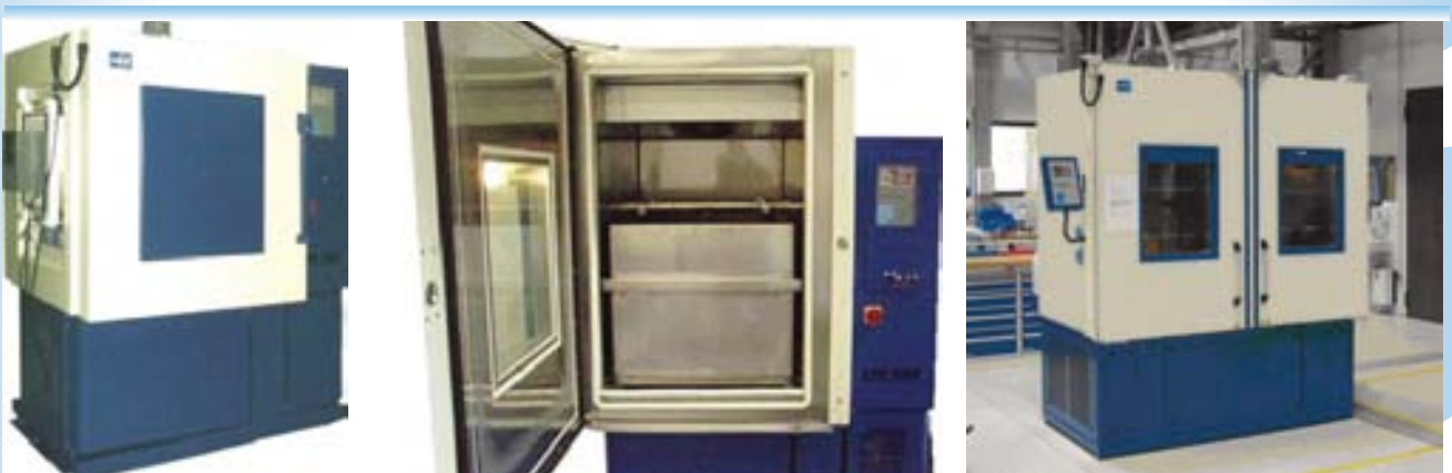
Klimaprüfkammer mit Sonnenlichtsimulation
